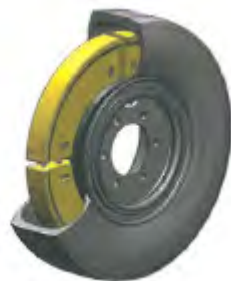
Schema della ruota portante con anello di sicurezza
